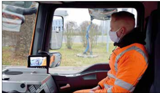
Ein akustisches und optisches Signal unterstützt die Fahrer der LKWs zukünftig beim rechts abbiegen. Foto Roland Beck
